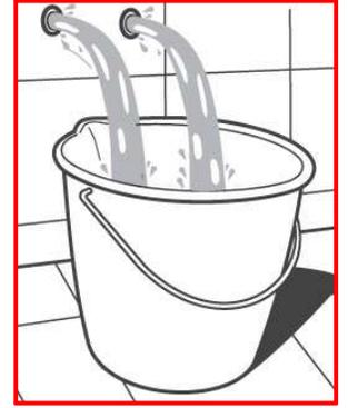
**Per installatore: Al fine di garantire la durata del prodotto installare rubinetti con filtro da pulire periodicamente. Effettuare risciacquo delle tubazioni prima di installare il prodotto (PUNTO 1). Eventuali residui se finissero all'interno della cartuccia potrebbero causarne il danneggiamento**
